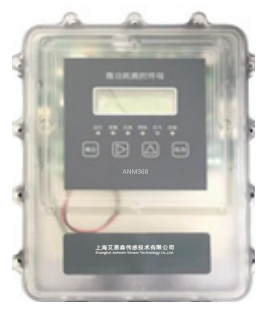
图8、安装密封胶圈，扣上外壳。
