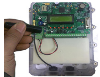
图6、连接流量计、脉冲表或其他变送器。
